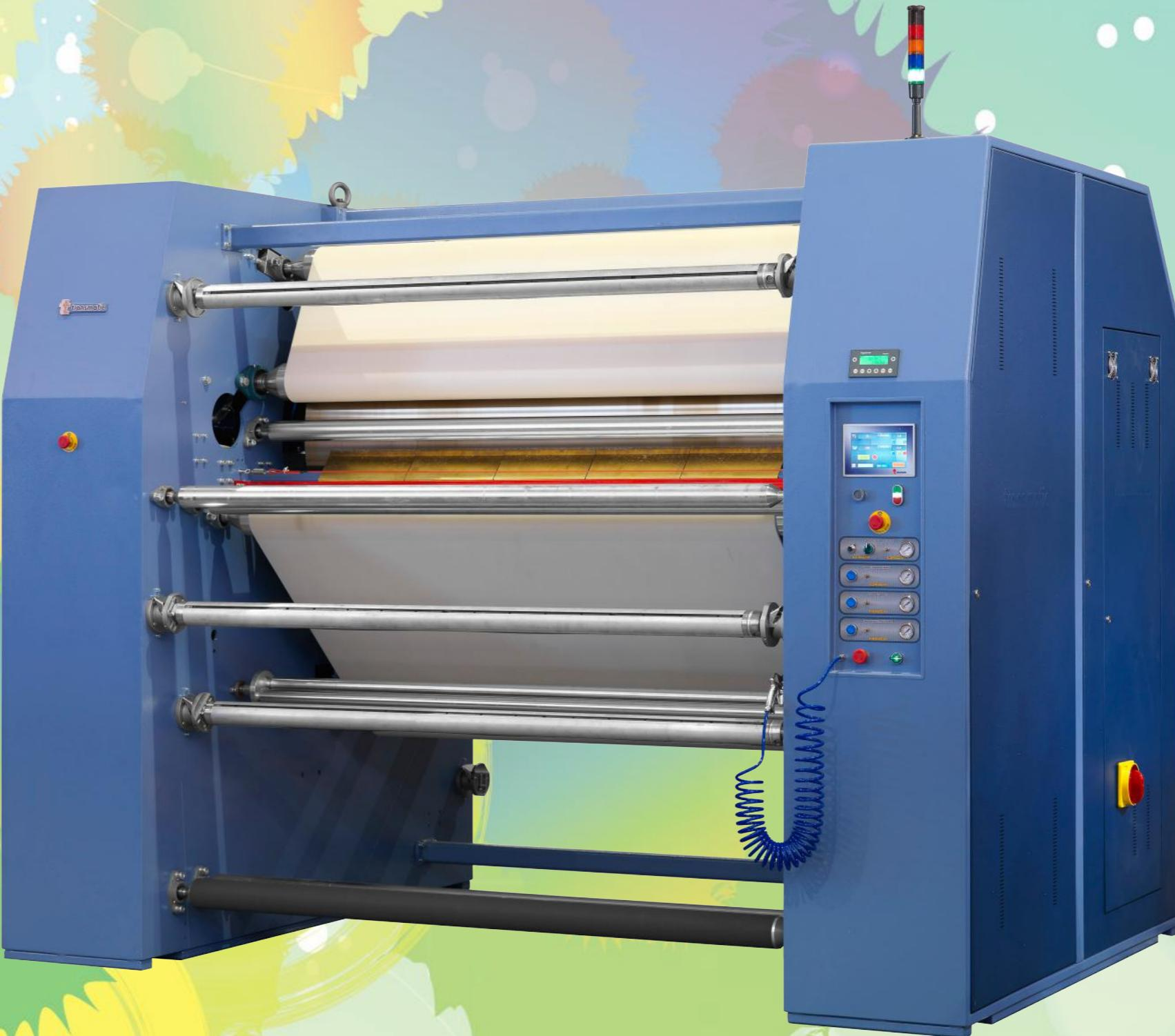
**I** Macchine rotative ad alta produttività (2,5 m/min - 2,7yd/min) per stampa transfer in sublimazione da carta transfer a tessuti sintetici, lavorati a maglia o stoffa non tessuta come poliestere, nylon, acrilico. Nel caso di stampe fatte direttamente su tessuto di poliestere con l'ausilio di stampanti digitali, si può usare la calandra per fissare i pigmenti di colore in modo perfetto ed economico.
